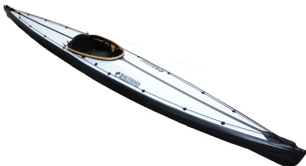
Le Karan 520 est le bateau d'expédition rapide de Nautiraid. Basé sur la coque du Narak 550, il diffère par des étraves droites et un franc-bord augmenté qui lui permet d'emporter plus de matériel à bord. Avec les stabilais, le Karan 520 peut être chargé avec 165 kg (poids du pagayeur + équipement) et abattre des journées de navigation de plus de 50 km.
